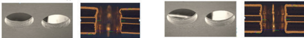
AP 材料的7 Mil盲孔 - 左: 传统化学沉铜, 右图: Via Dep 4550
