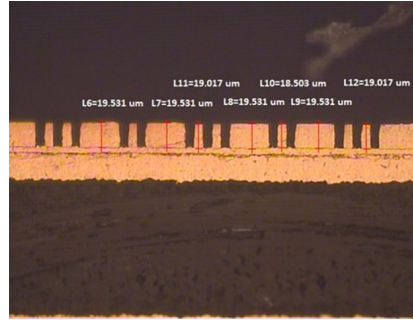
7/7 μm L/S线路于载体上
